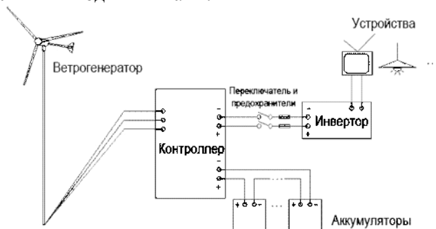
Рис. 3. Схема принципа работы ветровых установок
