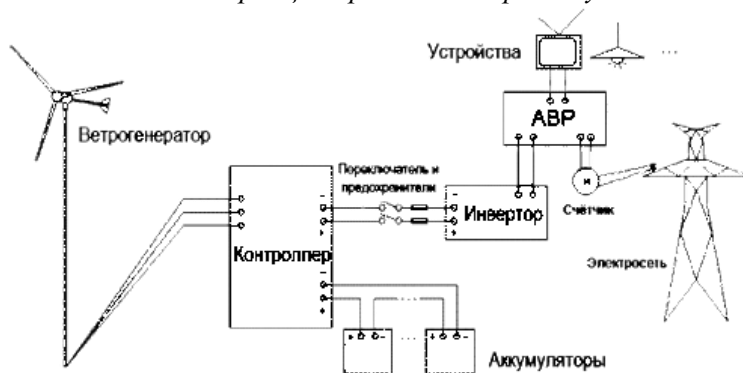
Рис. 3. Схема принципа работы ветровых установок
